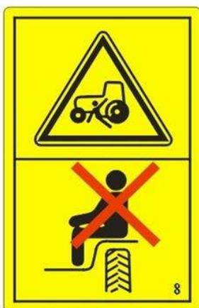
Значение: Запрещается сидеть на месте, не предназначенном для экипажа в тракторе, в противном случае это может привести к выпадению из машины.
